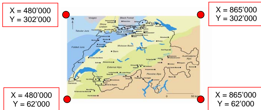
Figure 27 : Coordonnées géographiques des quatre coins de la carte tectonique de la Suisse dans le système GCS_CH1903.
