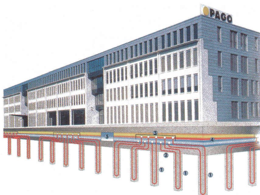
Figure 6-9. Bâtiment industriel reposant sur 570 pieux énergétiques fonctionnant comme source de chaleur et de froid. 1 : Pieux énergétiques, 2 : Conduites de raccordement, 3 : Collecteur primaire, 4 : Collecteur principal, 5 : Centrale énergétique (Lippuner AG, Grabs).
