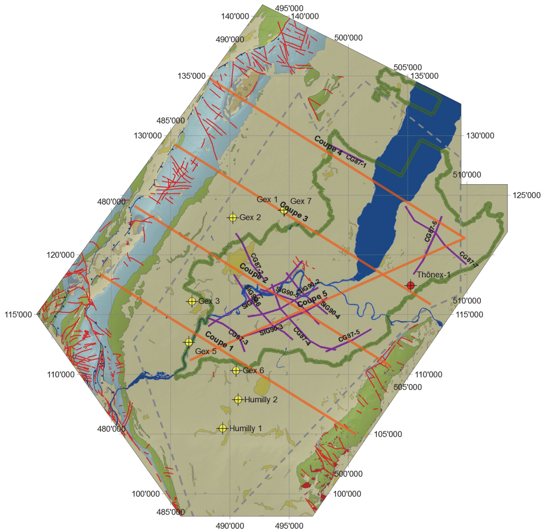
Figure 9-19. Implantation des coupes géologiques (traits orange). Le fond de carte représente la carte géologique et les couleurs des formations correspondent à celles de la figure 9-11. Les lignes rouges représentent les failles répertoriées et les lignes bleues les principaux chevauchements (d'après cartes BRGM 628, 629, 653, 654, 677 et 678). La ligne discontinue grise donne les limites de la partie « Bassin sédimentaire » à l'intérieur de laquelle les données sismiques ont été utilisées. Traits violets : lignes sismiques. Points jaunes : forages pétroliers. Point rouge : forage de Thônex.
