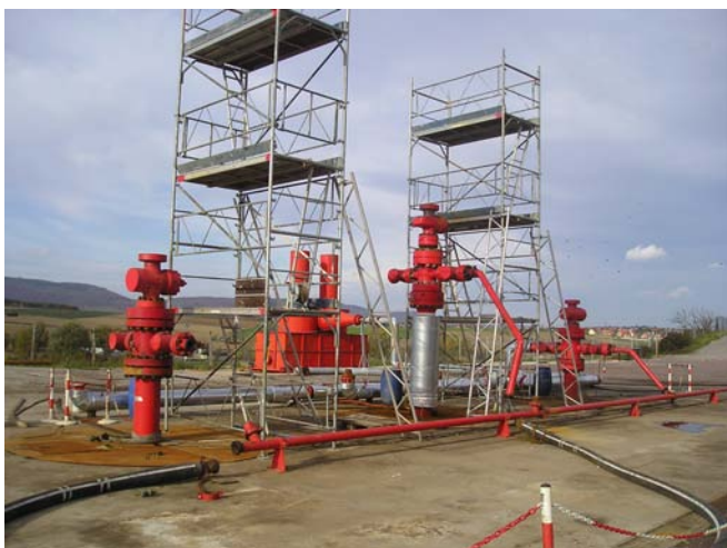
Figure 5.4.1 : Appareil de forage des puits à 5 km, trois pompes d'injection pour la stimulation hydraulique et trois têtes de puits sur le site du programme européen SGS de Soultz-sous-Forêts, Alsace.
