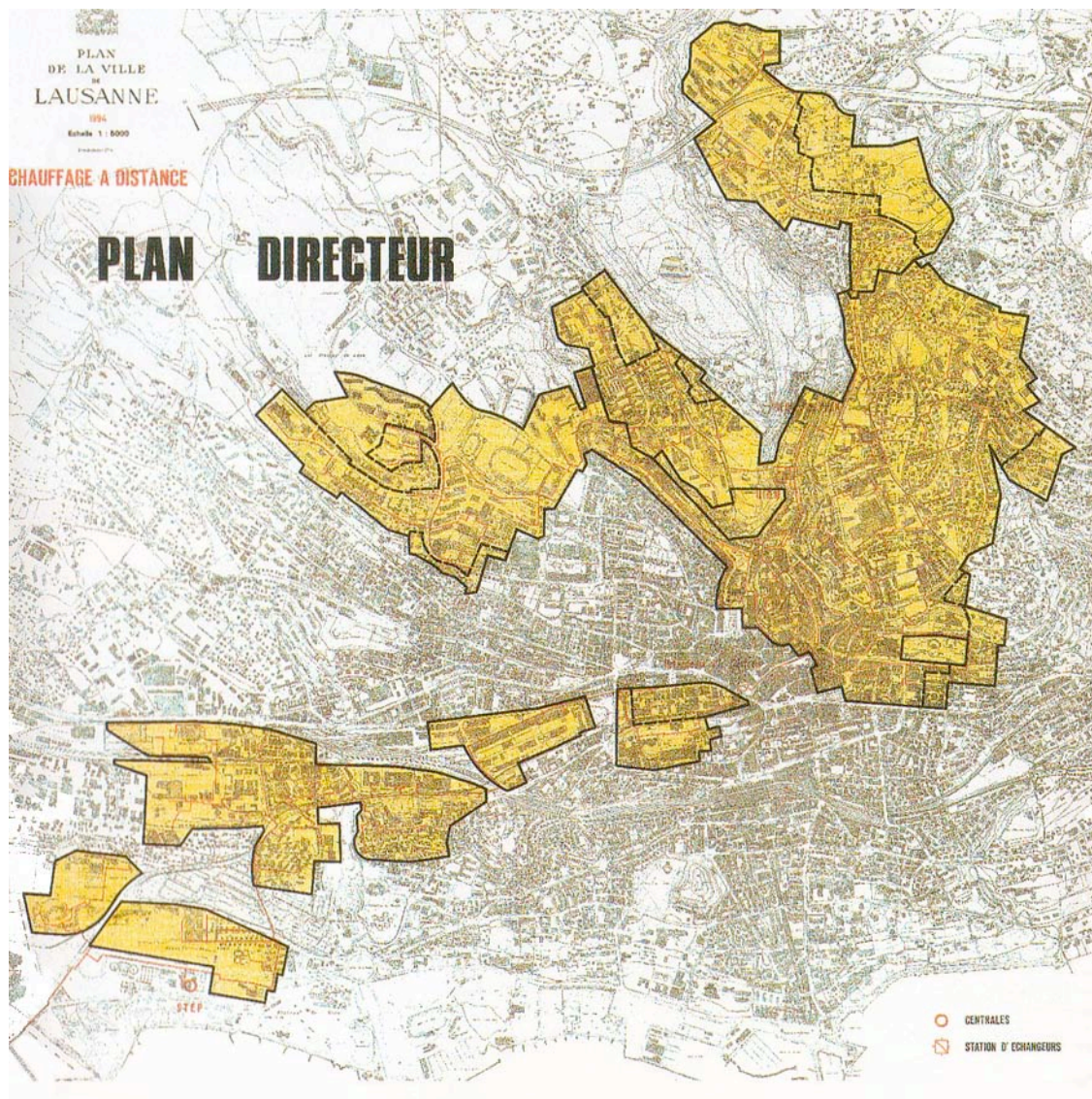
Figure 1.2.2 : Ville de Lausanne – Plan directeur du réseau de chauffage à distance (SI Lausanne).
