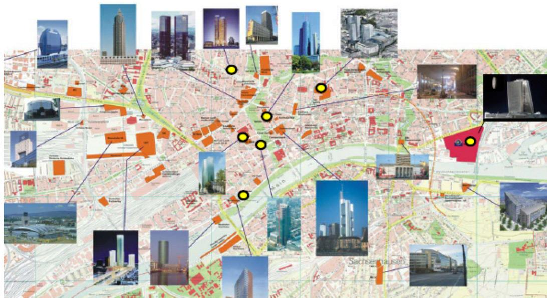
Figure 3.16. Bâtiments importants construits sur pieux énergétiques dans la ville de Francfort-sur-le-Main, en Allemagne (Katzenbach, 2007).
