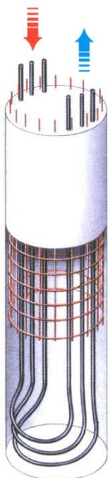
Figure 3.1. Schéma de principe d'un pieu énergétique moulé dans le sol avec sa cage d'armature et les conduites de circulation du fluide caloporteur.
