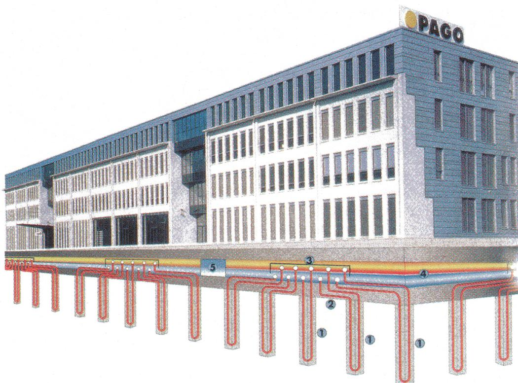
Figure 3.9. Bâtiment industriel reposant sur 570 pieux énergétiques fonctionnant comme source de chaleur et de froid. 1 : Pieux énergétiques, 2 : Conduites de raccordement, 3 : Collecteur primaire, 4 : Collecteur principal, 5 : Centrale énergétique (Lippuner AG).
